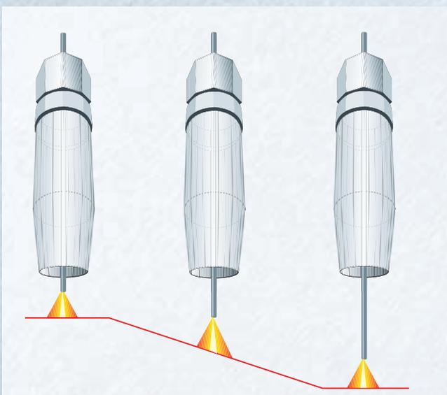
Longitud constante del arco voltaico aunque cambie el Stick-Out gracias a una regulación digital del proceso de soldadura.
