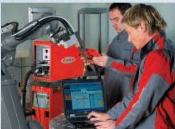
El control y la supervisión de los sistemas de soldadura, la gestión de la calidad basada en los datos de proceso nominales y reales, el análisis de resultados y errores hasta la documentación completa de los datos reales y nominales deseados se convierten en una rutina diaria, gracias al Xplorer de Fronius
