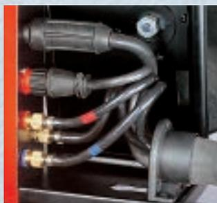
Dispositivo de fijación de antorcha en el carro de transporte „PickUp“.
