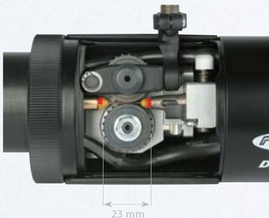
Transmisión de fuerza uniforme mediante los rodillos de impulsión engranados.
