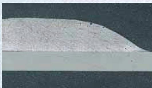
Unión CMT de acero galvanizado y aluminio. Soldadura en el lado de aluminio, soldadura indirecta en el lado de acero.
