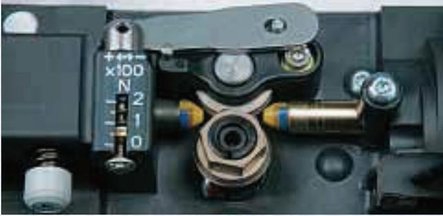
El nuevo sistema de palanca tensora en la antorcha proporciona una presión de apriete constante y reproducible.
