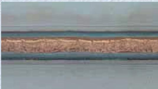
Unión realizada con soldadura indirecta CMT entre chapa galvanizada al fuego y con electrodo con una velocidad de soldadura de 2,0 m/min. Espesor de chapa 0,8 mm, material de aporte CuSi3.
