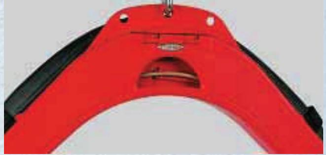
El buffer desacopla el accionamiento de hilo delantero y trasero y se encarga de que el transporte de hilo se realice sin problemas.
