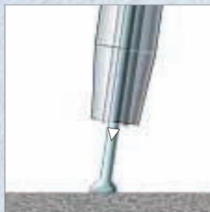
El movimiento de retorno del hilo soporta el desprendimiento de gota durante el cortocircuito. La corriente de cortocircuito se mantiene reducida.
